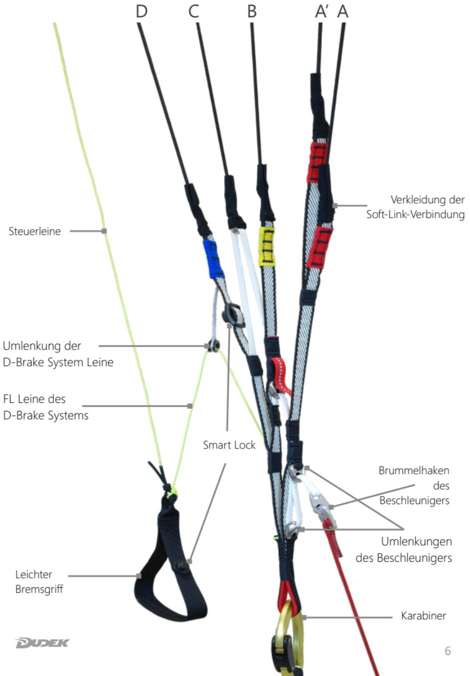
V-King ist mit einem sehr leichten 4-Ebenen-Tragegurt ausgestattet. Für eine bessere Unterscheidung im Notfall sind einige der Tragegurte farblich abgesetzt:
