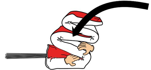
**12.** Stülpe den Innencontainer über den «S» gefalteten Rettungsschirm und drehe das gesamte Paket kopfüber. Lasse ein wenig Platz an der Vorderseite der Rettungsschirm-Vorderkante, um später die Leinen falten und verstauen zu können..
