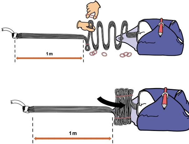
**15.** Schließe das letzte Blatt und mache den Innencontainer zu, indem eine 4 cm lange Leinenschleufe in die Hauptgummischleufe eingeschoben wird.
