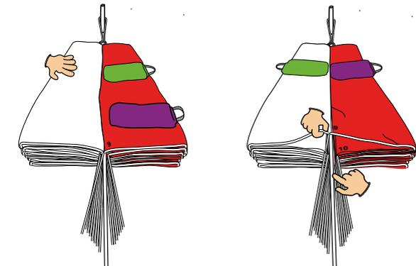
**7.** Hebe die oberste Leine auf, um zu kontrollieren, dass keine Stoffbahn in dem Windkanal (Kamin / Öffnungskanal) zu sehen ist und dass die Zentralleine schön frei in der Mitte liegt.
