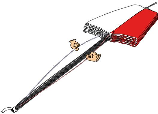
**9.** Falte die linken Bahnen der Länge nach auf eine S-förmige Weise unter die Mitte der Schirmkappe. Falte nun die rechten Bahnen der Länge nach auf eine S-förmige Weise über die Mitte der Schirmkappe. Halte die Schirmkappe mit Sandsäckchen oder Bücher schön gefaltet.
