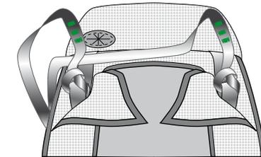
2. Verbinde die Verbindungsleinen mit einem rechteckigen 7 mm Edelstahlschraubschäkel (Inox). Verwende Gummiringe, um die Verbindungsleinen in den Schraubschäkeln in ihrer Position zu halten. Siehe unten.
