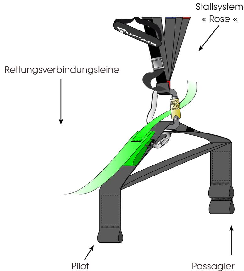
**3.** Auf beiden Seiten: Fädle den schmalen Gurt vom „Stallsystem Rose“ von hinten durch den Karabiner (an dem der Gleitschirmtragegurt eingehängt ist) und verbinde ihn mit einem Dreiecksschäkel zu der» B « oder « C « Ebene des Gleitschirmtragegurts – Die Namensgebung ist von Hersteller zu Hersteller unterschiedlich.
