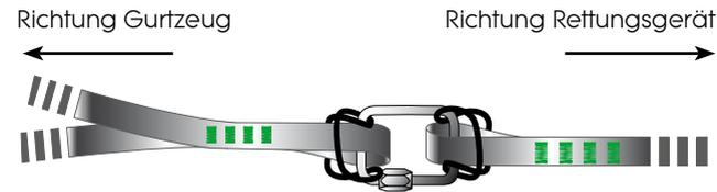
2. Verbinde die geteilten Gurte mit den Schulteraufhängungspunkten am Gurtzeug unter Verwendung von 6 oder 7mm Rechteckschraubschäkeln Edelstahl (Inox).
