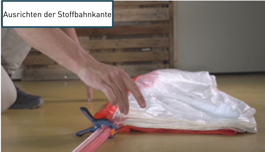
Glätten und ausrichten an der Faltenmarkierung.
