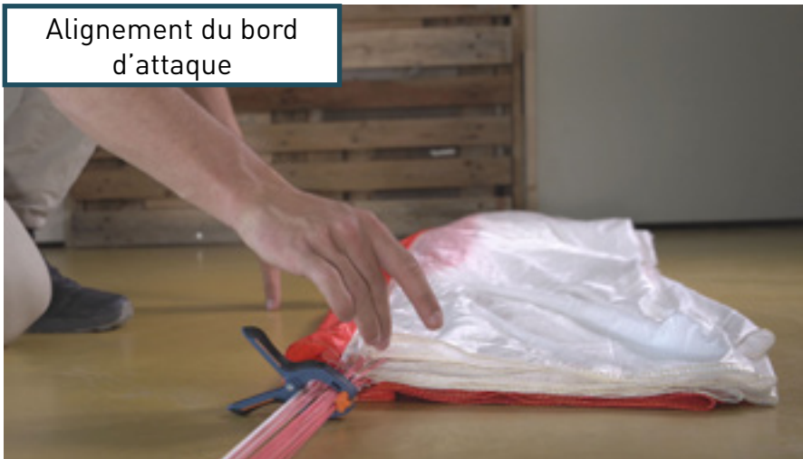
Mise à plat du premier panneau
