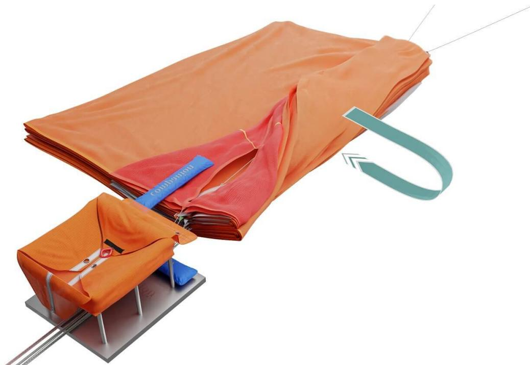
Fig. 36 Drehen des S-Schlags und anschliessendes Unterschieben.
