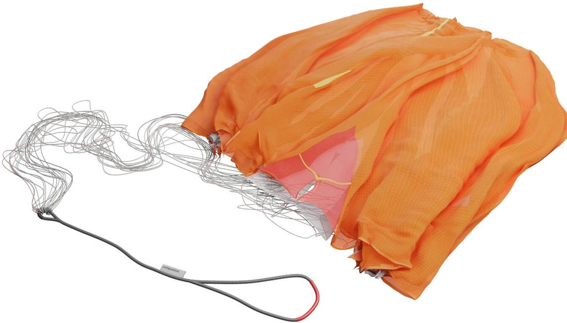
Fig. 5 Zum Lüften vorbereitete lockere Kappe
