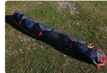
**Schritt 9** Drehe die Saucisse auf die Seite und falte den Schirm zum ersten mal nach den Verstärkungen der Anströmkante. Falte nicht die Plastikverstärkungen. Falte den Schirm 3 oder 4 mal um die Anströmkante herum.
