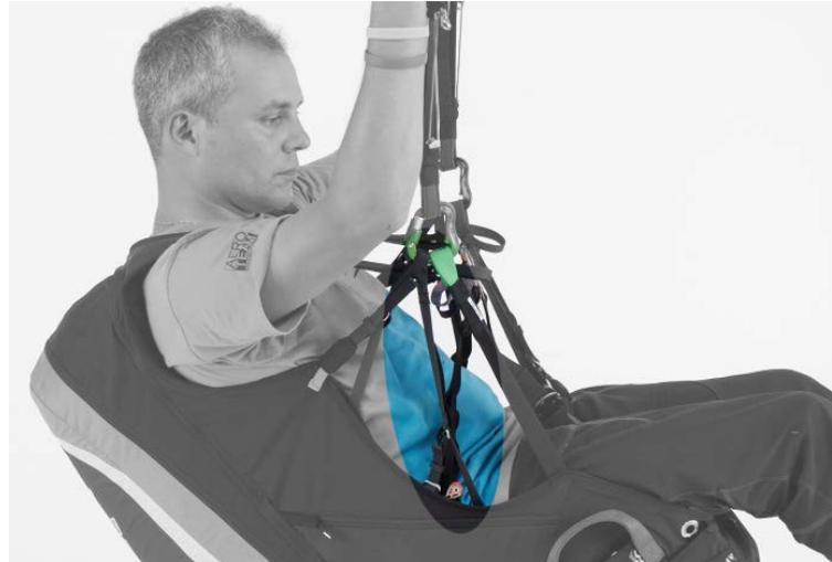
Diese Einstellung ändert den Winkel zwischen den Oberschenkeln und dem Rücken (Sitztiefe). So werden die Lasten zwischen der Sitzfläche und dem unteren Rücken verteilt und der Pilot sitzt bequemer. Auch diese Einstellung ist auf zwei Stellen für jede Seite unterteilt. Wenn Sie diese Einstellung verändern möchten, muss das Gurtband gelockert werden, wie auf den folgenden Fotos gezeigt.
