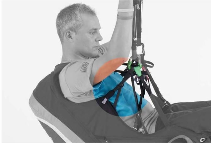
Auf diesem Foto kann man sehen, wie die Rückeneinstellung arbeitet, indem die Last auf zwei Stellen für jede Seite verteilt wird, um den Komfort zu verbessern. Diese Einstellung ermöglicht die Regulierung des Neigungswinkels des Oberkörpers gegenüber der senkrechten Flugachse.
