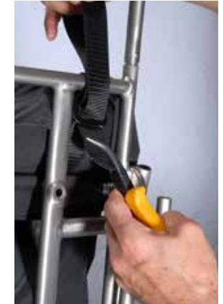
Ein Schraubenzieher um die Schließe zu halten und eine Zange um den Gurt zu ziehen können hilfreich sein.
