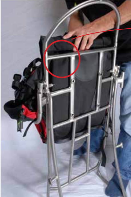
Gesamtübersicht der Befestigung des Rahmens mit dem Gurtzeug.
