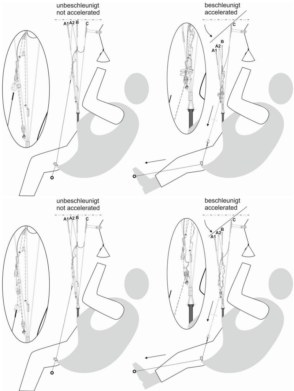
Fig. 2 Funktionsweise Fußbeschleuniger MIURA 2 RS ohne (obere Abbildung) und mit Speedlimiter (untere Abbildung)
