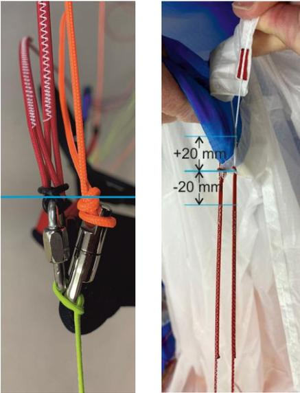
Fig. 8 **Meßpunkte für Bremsleinen Schnellcheck**
