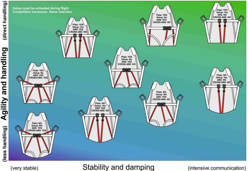
Fig. 6 Übersicht verschiedene Gurtzeuggeometrien und deren Dämpfung
