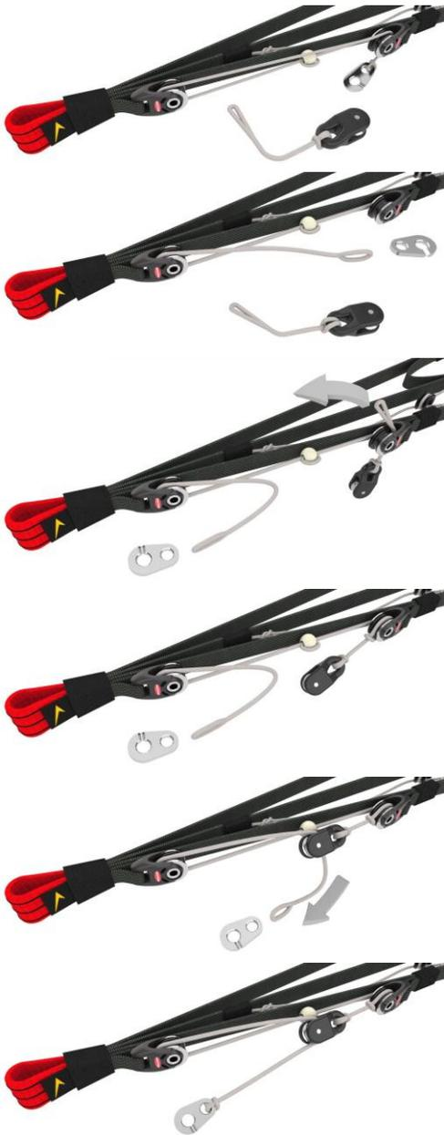
Fig. 4 **Bildserie Speedlimiter Einbau**
