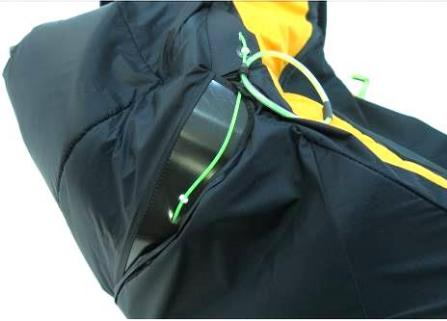
Abb. 40: Rettungsgriff mit eingeschobenen Splinten
