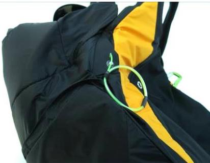
Abb. 41: Gurtzeug mit verschlossenem Rettungscontainer
