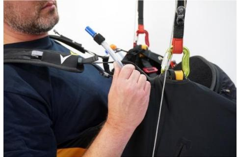
Abb. 4: Herausführen des Schlauches
