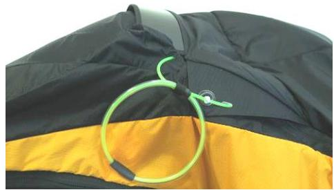
Abb. 38: Einfädeln des langen Splintes
