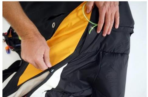
Abb. 43: Verschließen des V-Leinenkanals
