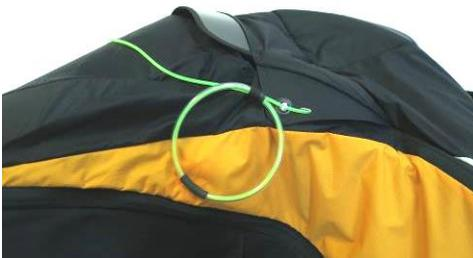
Abb. 37: Verschließen des oberen Loops
