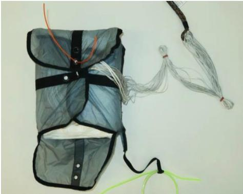
Abb. 30: Teilweise geschlossener Container mit inneren und äußeren Leinenbündeln
