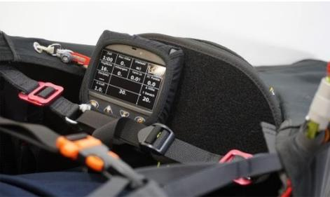
Abb. 24: Auflagefläche für Instrumente
