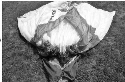
3. Nun wird die geraffte Eintrittskante seitwärts auf den Innenpacksack bzw. AirPack gelegt und mittels Gurtbandes direkt hinter den Nylonstäbchen fixiert.
