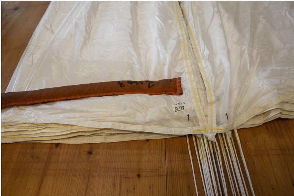
Die Bahnen mit dem Schlitz werden Kegelförmig gelegt.
