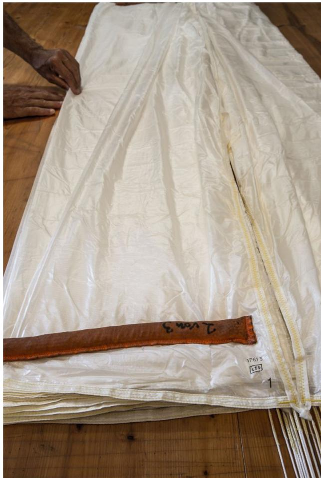
Die Bahn 1 wird dann mit Packgewichten oben und unten fixiert. Danach schlägt man alle Bahnen der rechten Seite nach links.
