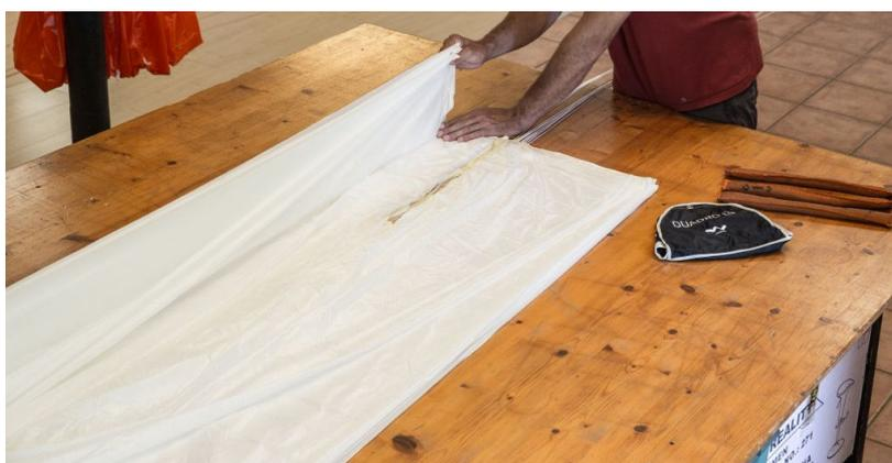
Zwei Drittel der linken Seite werden unter den Schirm geschlagen. Dies geht am besten mit einem Helfer am oberen Ende der Kappe, der die Bewegung synchron mitmacht.
