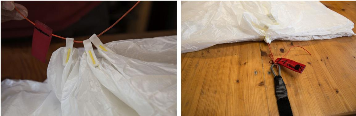
Am unteren Ende des Packtisches wird der Fanggurt fixiert und das Rettungsgerät gespannt.
