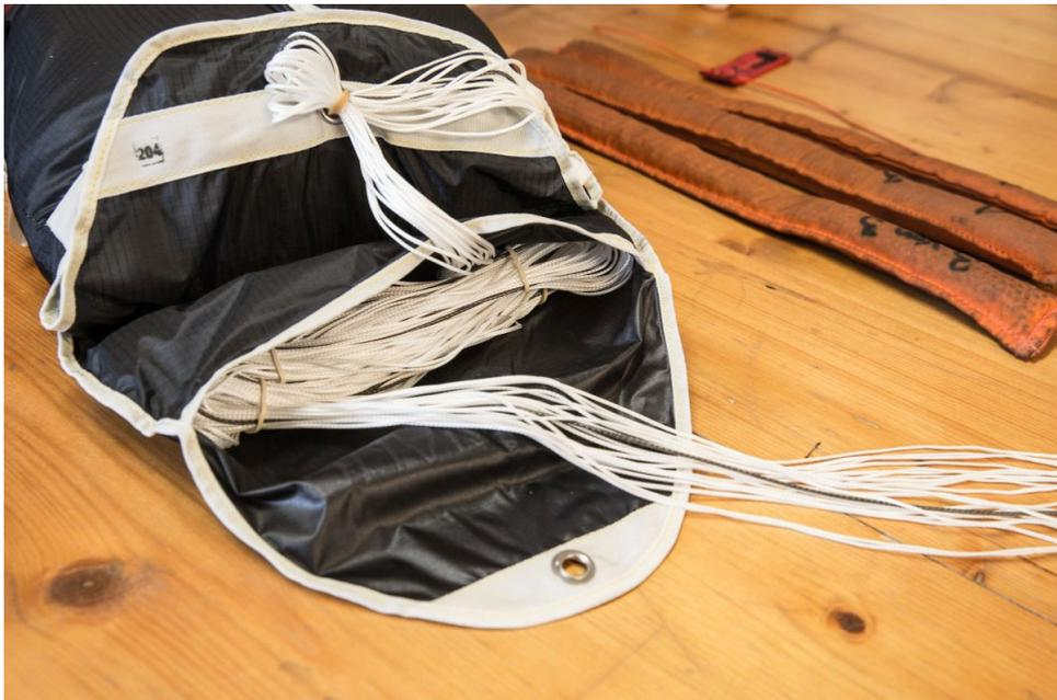
Der Innencontainer wird dann mittels des bereits eingebauten, robusten schwarzen Gummibandes verschlossen und mit den restlichen Fangleinen verriegelt.
