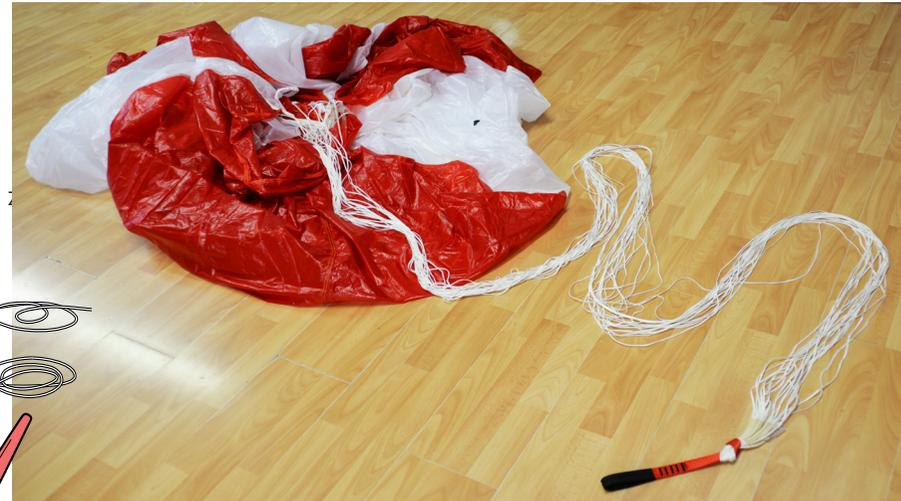
**b. Befestige den Rettungsschirm an einem festen Punkt um ihn zu strecken und unter Spannung zu legen.**
