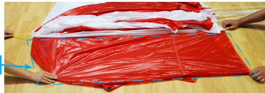
Folge der Stoffbahnkante um die dritte Stoffbahn zu finden. Diese Stoffbahn ist weiss und wird in einem Schritt flach rechteckig gelegt.
