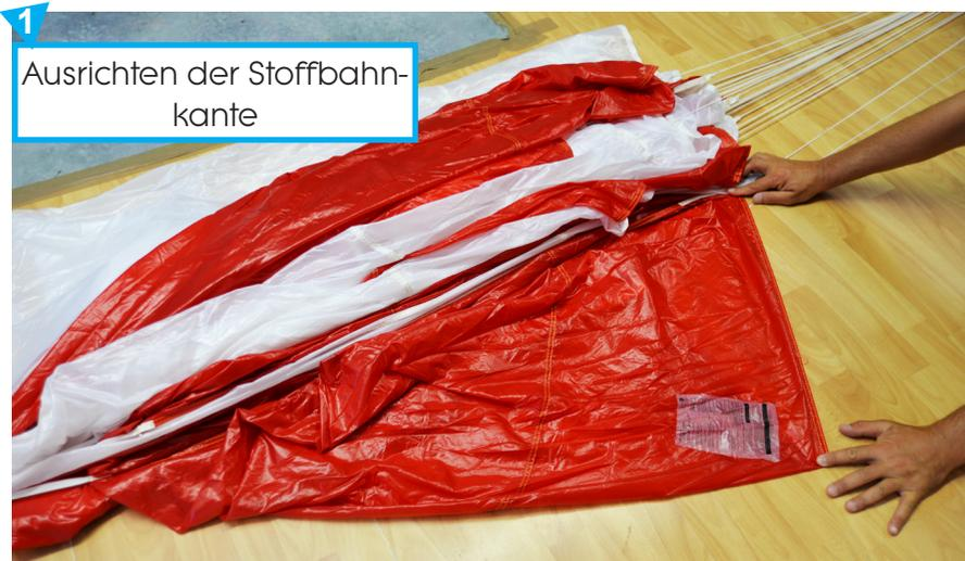
Folge der Stoffbahnkante um die zweite Stoffbahn zu finden. Diese Stoffbahn wird geglättet und in rechteckiger Form verlegt.
