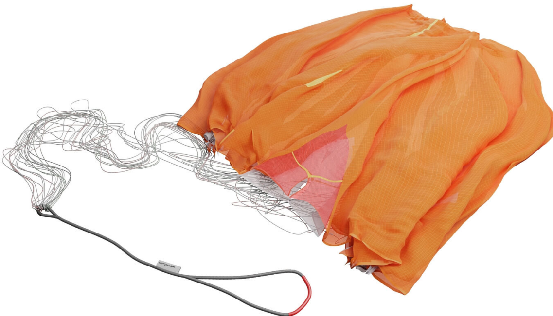
Fig. 5 Zum Lüften vorbereitete lockere Kappe
