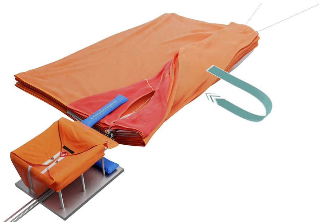
Fig. 37 Drehen des S-Schlags und anschliessendes Unterschieben.
