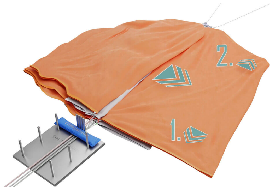
Fig. 29 Erhalten einer geraden Unterkante.
