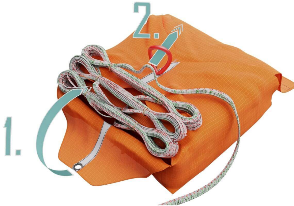
Fig. 45 Leinenbündel im Container, bereit für das letzte Containerblatt.
