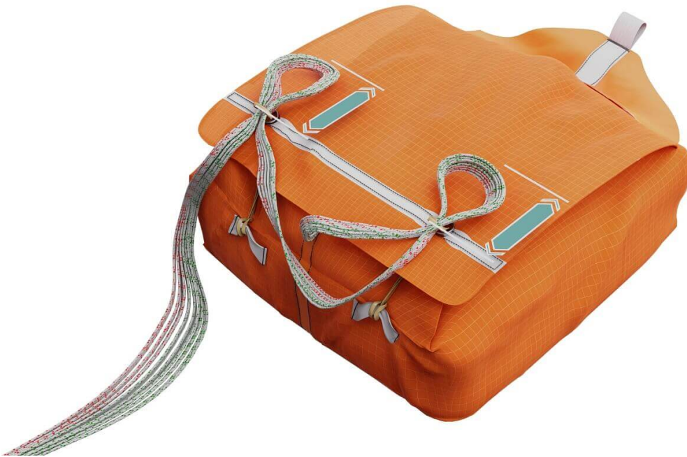
Fig. 48 Leinenschlaufen zum Verschliessen des Containers.
