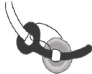
**Als Sollbruchfaden darf nur dafür zugelassenes Material eingesetzt werden, da eine zu hohe Bruchlast die Betriebssicherheit gefährdet!**
