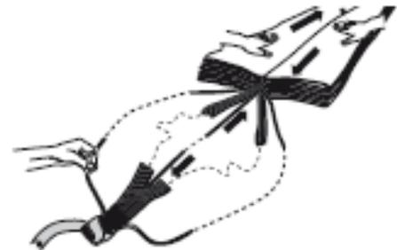
Nach dem Ordnen werden die Bahnen in zwei gleiche Hälften geteilt, jeweils links und rechts gleich viele Bahnen, so dass die Kappe dann wie auf dem Bild liegt
