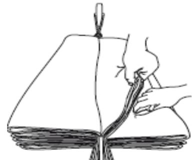
Danach wird die linke Seite auf die Rechte geklappt, und anschließend jede Bahn einzeln sauber wieder auf ihre alte Seite zurückgelegt wobei die Bahnen präzise aufeinander liegen müssen. (achte auf die Nummerierung der Bahnen, die erste Bahn auf der linken Seite ist die 1.
