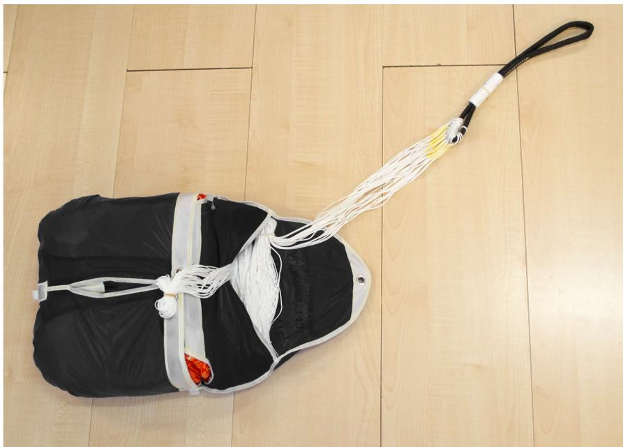
Der Innencontainer wird dann mittels des bereits eingebauten, robusten schwarzen Gummibandes verschlossen und mit den restlichen Fangleinen verriegelt.
