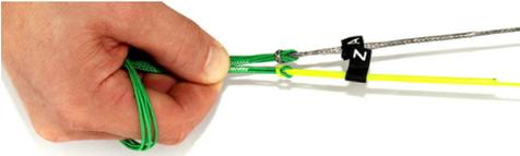
**2** Bringe den Mixer auf Spannung und fixiere die Enden der Frontmain- und Backmain-Leine, zum Beispiel indem sie ein Helfer festhält. Diese Position sollte für die Dauer des Mixertests nicht verändert werden.
