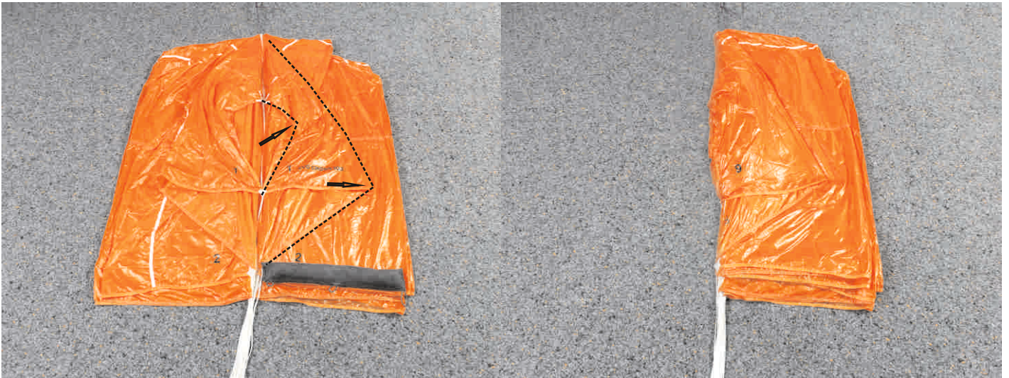
13. Bahn 1 legen (Eckbahn) und Basis mit Gewicht beschweren.
