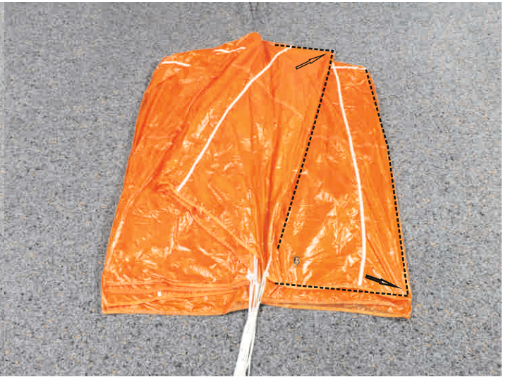
8. Bahn 6 legen und den oberen Teil der Bahn 5 seitlich herausziehen. (Evo Cross 160: Bahn 7, oberer Teil der Bahn 6)
