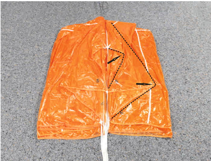
9. Bahn 5 legen (Eckbahn) (Evo Cross 160: Bahn 6)
