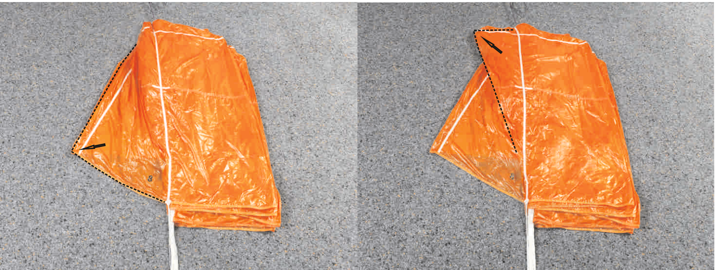
15. Bahn 9 (Evo Cross 160: Bahn 11) mittig zum Boden legen und die Bahn 8 (Evo Cross 160: Bahn 10) zur Seite rausziehen.
