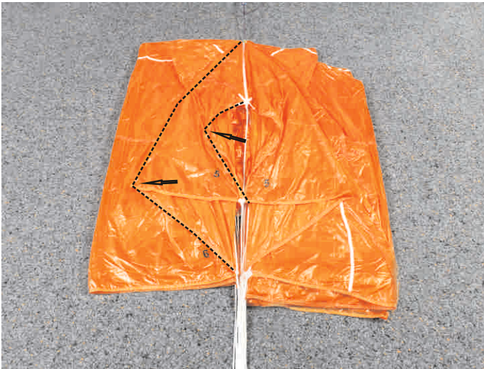
19. Bahn 5 legen (Eckbahn) (Evo Cross 160: Bahn 6)
