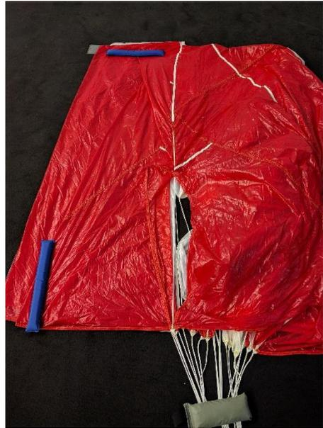
5. Bahn 3 legen: Den oberen Teil der Bahn so weit zur Seite herausziehen, dass die Bahn in etwa ein Rechteck bildet. Wiederholen Sie das mit den nächsten Bahnen, bis Sie auf die nächste Bahn mit Schlitz treffen.
