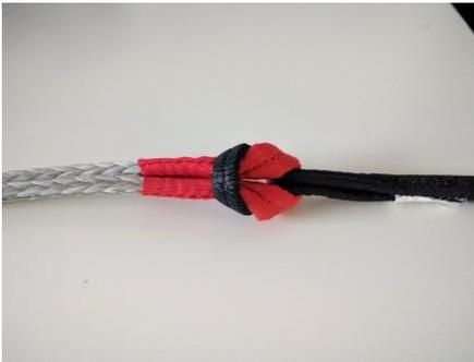
22. Verbindungsleine des Retters und V-leine durch Einschlaufen miteinander verbinden. Die Verbindung muss zentriert im Bereich des Scheuerschutzes liegen.
