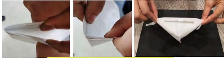
Item #2 : Fatigue test for nose slit( 5 cycles)
