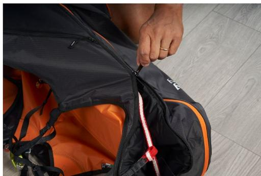
Schiebe die beiden Splinte aus grünem Kunststoff in die elastischen Schlaufen und anschließend unter die vorgesehene Abdeckung zwischen den beiden Ösen.
