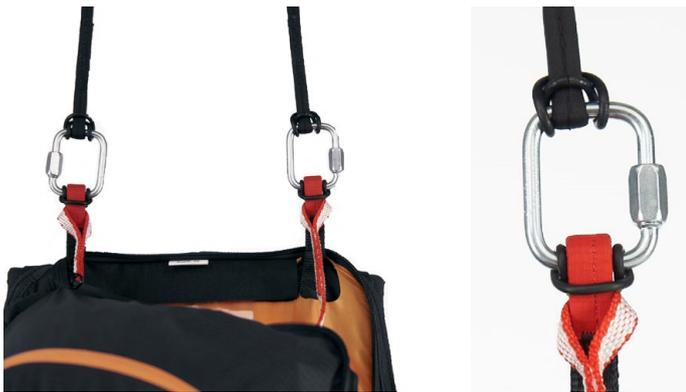
Die beiden Anschlüsse werden mit Schraubschäkeln mit einer Bruchfestigkeit von mindestens 1400 kg hergestellt. Auf alle Fälle ist zu prüfen, dass die Länge der Verbindungsleine und der Hauptleine des Rettungssystems lang genug ist, um eine freie und ungehinderte Rettungsöffnung zu gewährleisten.
