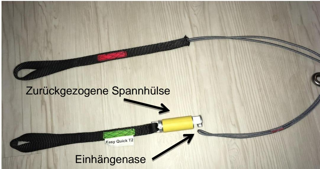
Abbildung 5.1: Spannhülse zurückgezogen
