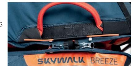
3. Nachdem das Rettungsgerät richtig in das Gurtzeug eingelegt wurde, muss es mittels der Splinte am Rettungsgriff verschlossen werden. Dazu benötigst Du zwei kurze Hilfsleinen (aufgrund der geringen Reibung empfehlen wir hierfür unummantelte, nicht allzu dünne Gleitschirmleinen), die Du in die beide Schlaufen am Außencontainer einfädelst. Ziehe die beiden Schlaufen mit Hilfe der Hilfsleinen durch die beiden Ösen.
