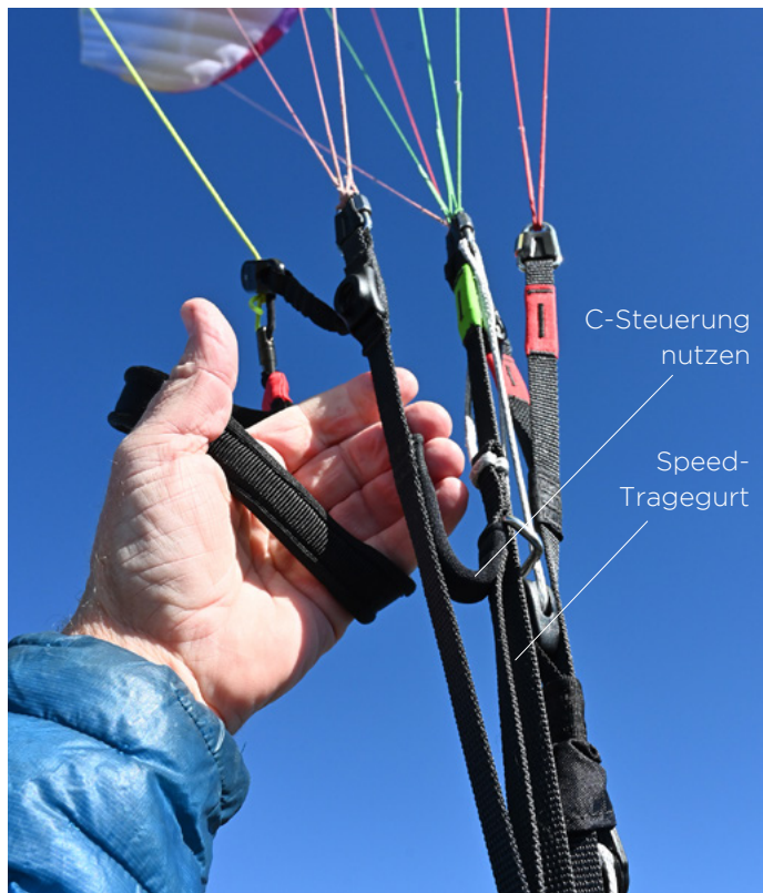
Abb. 1: Behalten Sie die Steuergriffe in den Händen während Sie die C-Steuerung nutzen.
