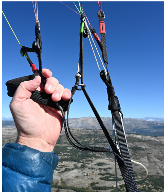
Abb. 1: Behalten Sie die Steuergriffe in den Händen während Sie die C-Steuerung nutzen.
