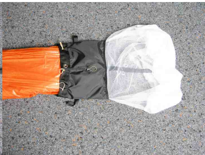
10. Oberes Kappenende in den Innencontainer einlegen.
