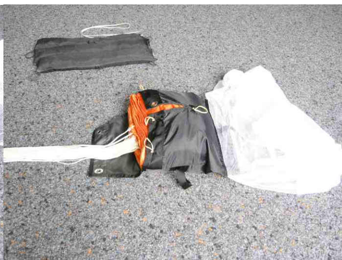
12. S-Schläge in den Innencontainer einlegen.
