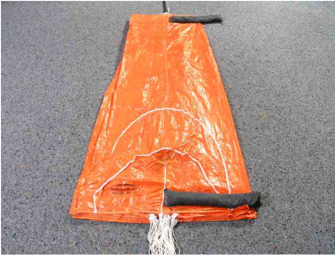
3. Alle Bahnen legen. bis die Bahn 1 (Stempelbahn) oben liegt und mit Packgewichten beschweren.
