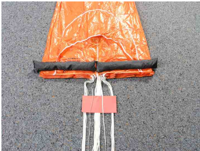
7. Fangleinen 1 und 20 (Annular Classic 20, Piccolo Classic) und Mittelleinen auf kreuzungsfreien Verlauf kontrollieren. (Annular Classic 22/22HG: 1 und 22; Annular Classic 24/24HG: 1 und 24; Annular Classic Tandem/ Tandem HG: 1 und 30; Annular Classic 36 Tandem/36 Tandem HG: 1 und 36)
