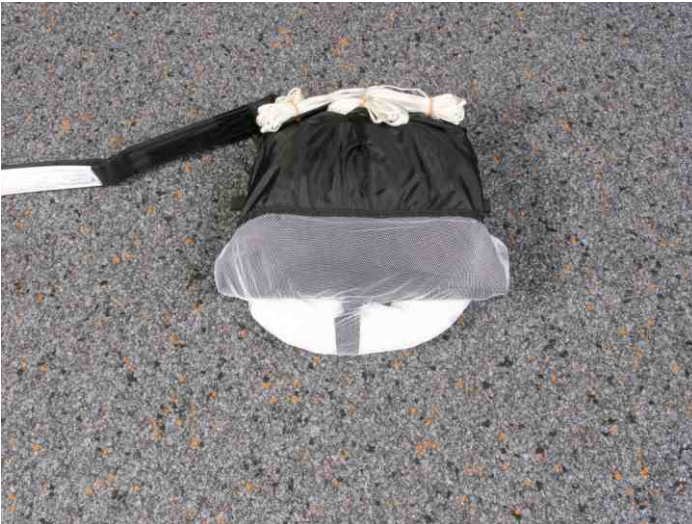
15. Hilfsschirm einrollen. Hinweis: entfällt beim Piccolo Classic, da dieser keinen Hilfsschirm besitzt.
