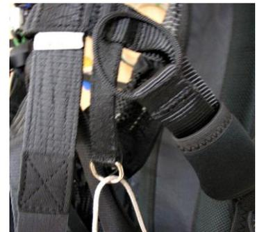
Stelle die Seillänge so ein, dass im maximal beschleunigten Flugzustand (beide Umlenkrollen der Tragegurte liegen dabei aufeinander) die Beine ganz durchgestreckt sind.
