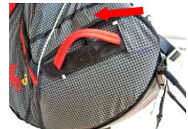
Der Rettergriff wird noch mit einem Sollbruchfaden gesichert, indem du diesen durch die beiden weißen Laschen (eine am Rettergriff, die zweite am Gurtzeug) ziehst. Dieser muss eine Bruchlast von 50 N aufweisen, um das ungewünschte Auslösen der Rettungssystems zu vermeiden.
