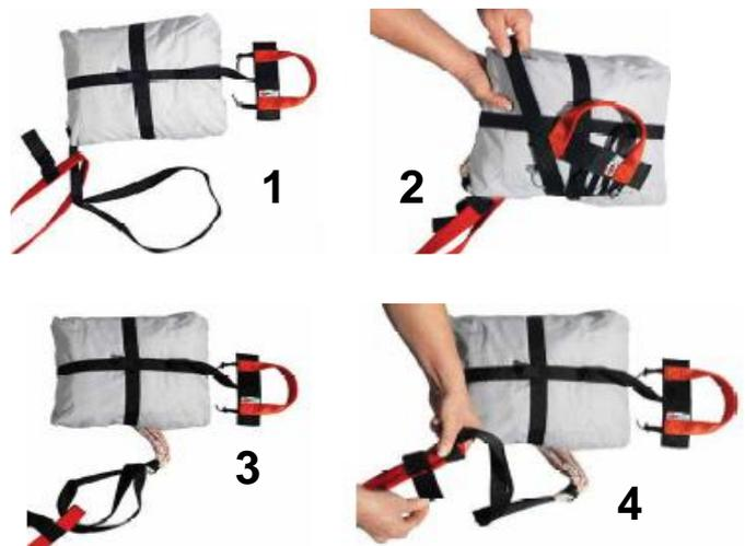
Lockert sich der Knoten und die beiden Gurte sind nicht mehr fest verbunden, würde bei Öffnung des Rettungsgerätes (durch die entstehende Reibung beim Straffen der Gurte) eine derartige Belastung entstehen, dass die Gefahr des Reißens der Gurte gegeben ist.
