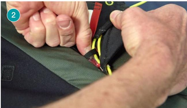
... über die Schulter bis hin zum linken Retterfach. Führe ihn dort über das Ende hinaus bis hinter das Sichtfenster. Damit stellst du sicher, dass die Auslösung nicht durch den Slider blockiert wird.
