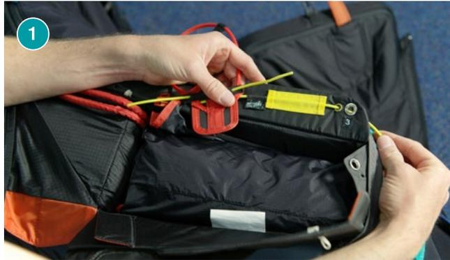
Langes gelbes Verschlusskabel durch die gelbe Lasche auf der Innenseite der oberen Verschlussklappe stecken und durch das gelbe Loch neben der Verschlussöse nach aussen führen.
