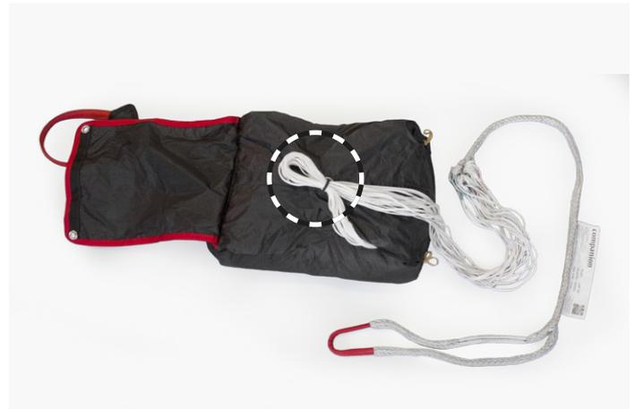
Schliesse nun die äussere Klappe des Containers (rot eingefasst) mit zwei Leinenschlaufen in der gleichen Länge (5 bis 6 cm) wie du sie beim Schliessen des letzten Containerblatts verwendet hast. Die beiden Leinenschlaufen werden mittels zweier Gummibänder am Container gesichert, die zuvor durch die zwei Ösen der äusseren Containerklappe geführt wurden.
